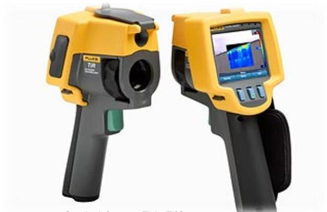
Caméra infrarouge Fluke Ti32
